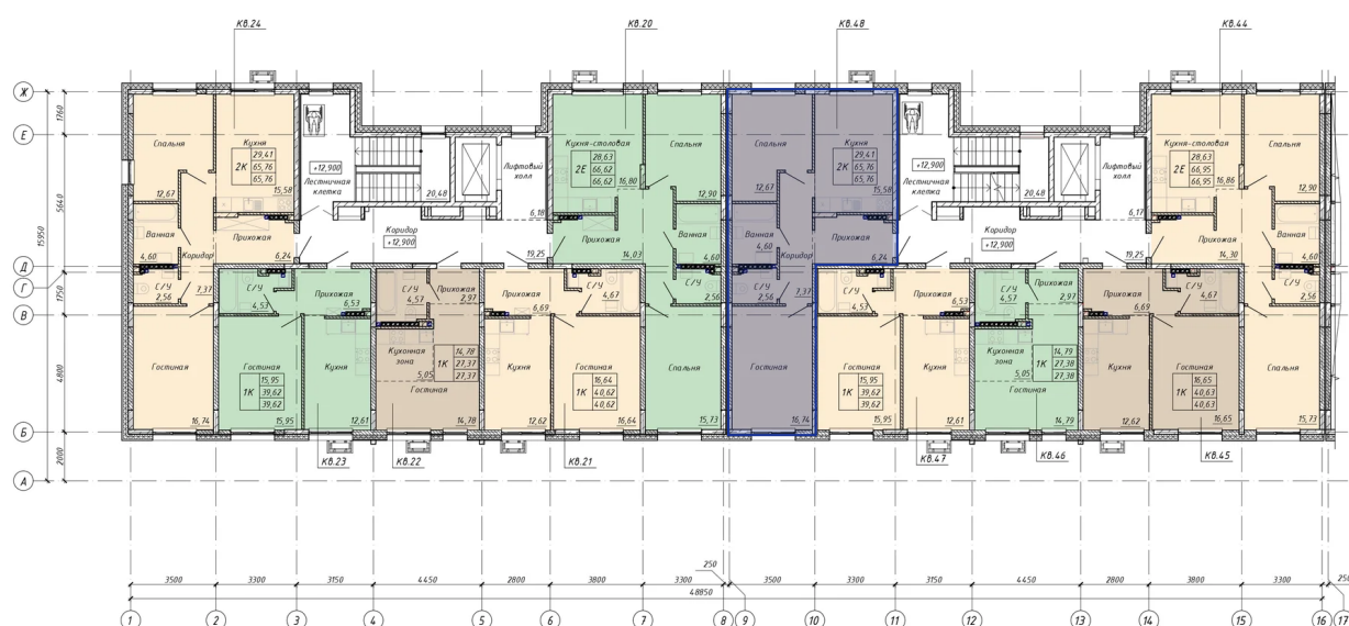
Полэтажные планы 5 этажа дома №1 (ОКС-1.1) Секция 1,2 Подъезд 1,2
