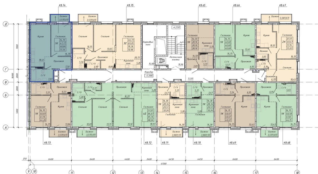
Поэтажные планы 2 этажа дома №3 (ОКС-1.3) Секция 2 Подъезд 2
