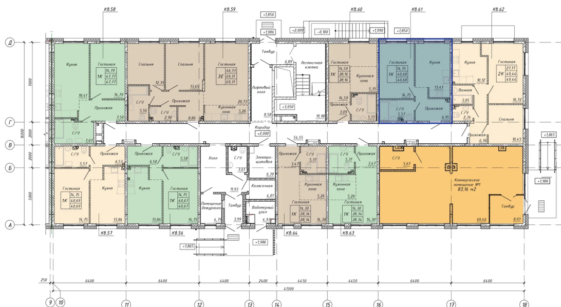
Поэтажные планы 1 этажа дома №3 (ОКС-1.3) Секция 2 Подъезд 2
