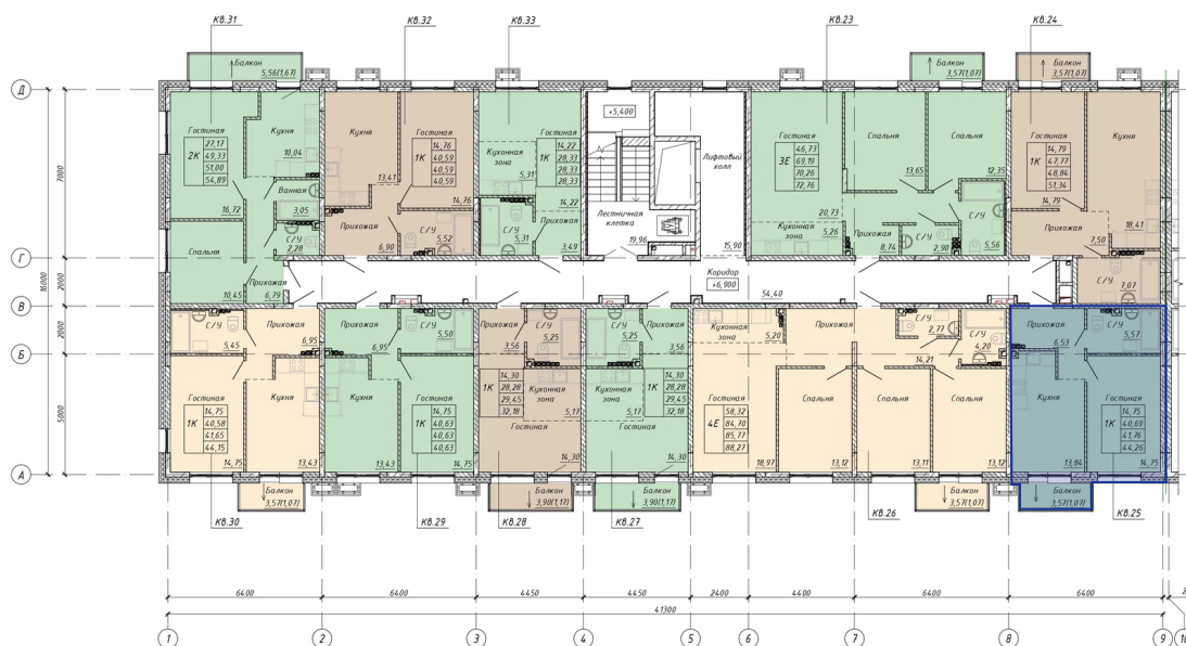
Поэтажные планы 3 этажа дома №3 (ОКС-1.3) Секция 1 Подъезд 1
