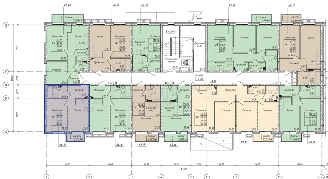
Поэтажные планы 2 этажа дома №3 (ОКС-1.3) Секция 1 Подъезд 1
