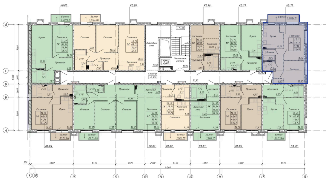
Поэтажные планы 3 этажа дома №3 (ОКС-1.3) Секция 2 Подъезд 2
